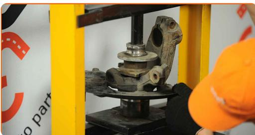
Substituição: rolamento da roda – Skoda Octavia 1U. Conselho da AUTODOC:
