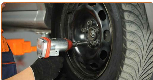
61 Baixar o carro e trabalhar em ordem transversal, apertar os parafusos das rodas. Use o soquete de impacto para roda #17. Use uma chave de torque. Aperte-o para o torque de 120 Nm.
