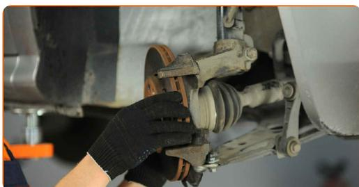
**53** Aperte a fixação do disco de travão. Use Torx T30. Use uma chave de torque. Aperte-o para o torque de 4 Nm.
