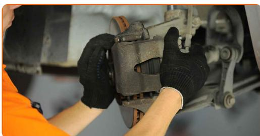
**54.2** Use HEX n.º H7 Use uma chave de torque. Aperte-o para o torque de 28 Nm.
