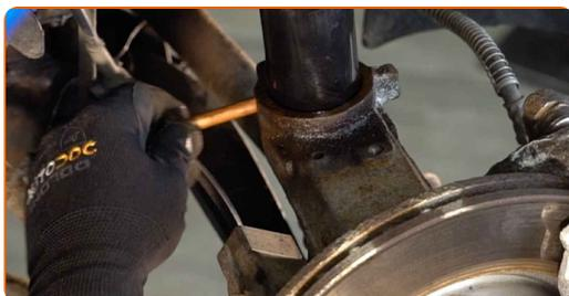
40 Aperte os fixadores inferiores do dispositivo amortecedor. Use uma chave combinada nº 18. Use uma chave soquete nº 18. Use uma chave de torque. Aperte-o para o torque de 60 Nm.+90°
