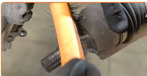
**42** Instale a manga de eixo no eixo da junta homocinética.
