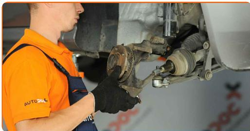
38 Fixe o suporte do amortecedor na manga de eixo. Use um martelo de borracha.
