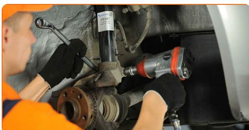
25 Remova o parafuso de fixação.
