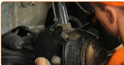
**16** Desconecte os fios do sensor ABS. Use uma chave de fenda plana.
