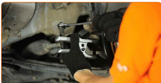
12 Desaparafuse a extremidade da barra de direção.
