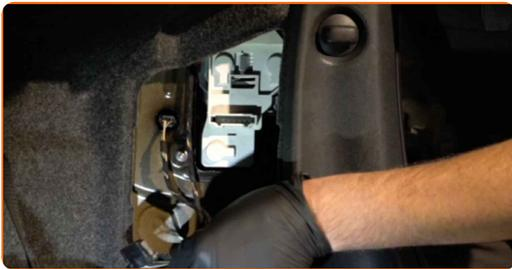
6 Desaperte os fixadores que ligam a luz traseira à carroçaria do veículo. Use uma chave soquete nº 8. Use uma chave de catraca.
