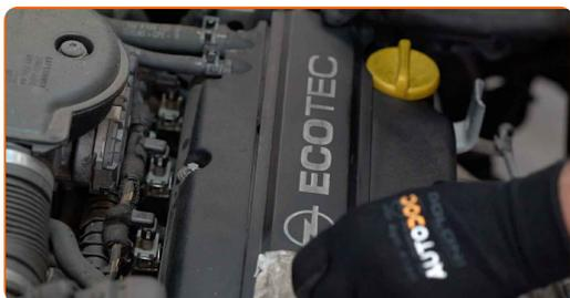
**18** Ligue o motor por alguns minutos. Isso é necessário para garantir que o componente funcione corretamente. Desligue o motor.
