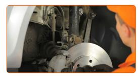
Aperte os fixadores inferiores que conectam a coluna de suspensão à manga de eixo. Use uma chave combinada nº 18. Use uma chave soquete nº 18. Use uma chave de torque. Aperte-o para o torque de 85 Nm.+90°
