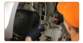
Separe o conetor do sensor ABS. Use uma chave de fenda plana.
