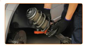
Aparafuse a fixação superior de montagem do suporte do amortecedor. Use alicates de bomba de água.
