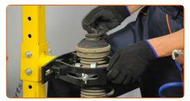
Remova a tampa do suporte de montagem da suspensão. Use uma chave de fenda plana.
