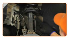
Desaparafuse o fixador que conecta a bieleta da barra estabilizadora à coluna do amortecedor. Use uma chave combinada nº 19. Use HEX n.º H5. Use uma chave de catraca.
