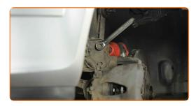
Retire os parafusos de fixação (2 peças).
