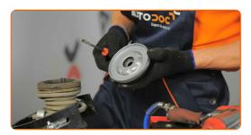
Aperte a porca do suporte do amortecedor da haste do pistão. Use uma chave soquete nº 21. Use uma chave de torque. Aperte-o para o torque de 65 Nm.
