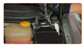
Instale a tampa do suporte de montagem da suspensão.
