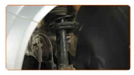
Desaparafuse o fixador que conecta bieleta da barra estabilizadora à barra estabilizadora. Use uma chave combinada nº 19. Use HEX n.º H5. Use uma chave de torque. Aperte-o para o torque de 60 Nm.
