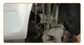
Instale o terminal do estabilizador transversal.
