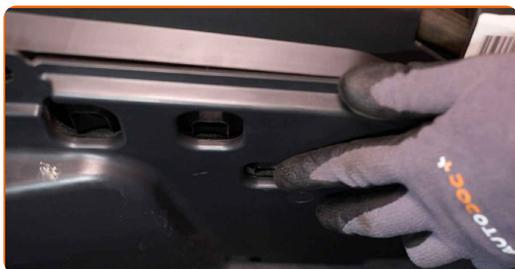
**16** Aperte os elementos de fixação do painel lateral do lado do passageiro.
