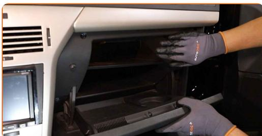
**19** Aparafuse os parafusos de fixação do porta-luvas. Use Torx T20.
