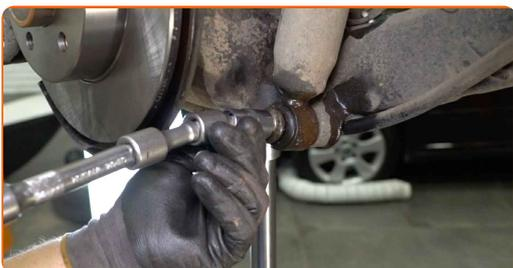
**9** Remova o parafuso de fixação.
