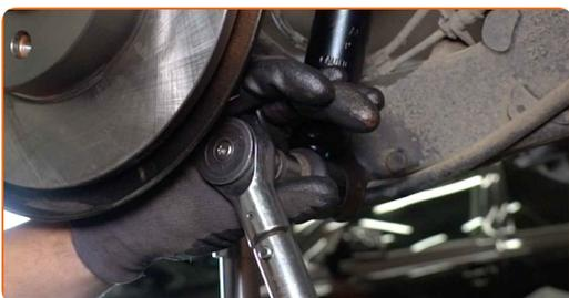
**20** Apertar a fixação superior do amortecedor. Use uma chave soquete nº E18. Use uma chave de torque. Aperte-o para o torque de 90 Nm.
