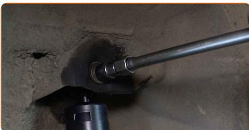
**21** Remova o apoio sob a viga do eixo traseiro.
