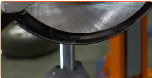
**19** Aperte a fixação inferior do amortecedor. Use uma chave soquete nº E20. Use uma chave de torque. Aperte-o para o torque de 130 Nm.
