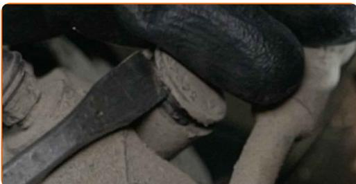
**11** Desparafuse a fixação de pinça de travão. Use HEX n.º H7. Use uma chave de catraca.
