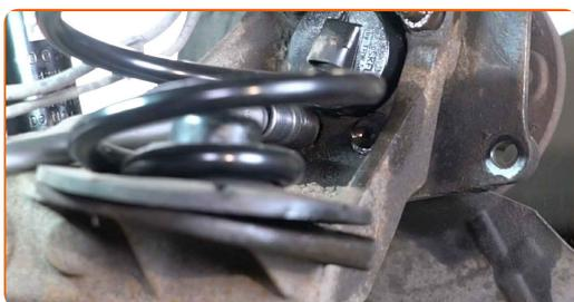
**22** Desaparafuse o fixador do suporte da cablagem de ABS. Use uma chave soquete nº E8. Use uma chave de catraca.
