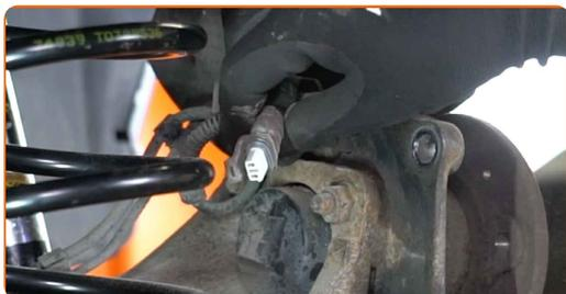
**20** Limpe os elementos de fixação do rolamento do cubo da roda. Use uma escova metálica. Use spray WD-40.
