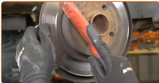
**16** Desaperte a fixação do disco de travão. Use Torx T30. Use uma chave de catraca.
