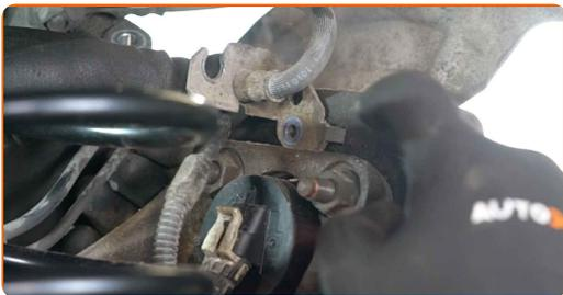
**35** Aperte o fixador do suporte da cablagem de ABS. Use uma chave soquete nº E8. Use uma chave de torque. Aperte-o para o torque de 7 Nm.
