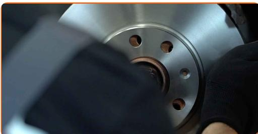
**18** Aperte a fixação do disco de travão. Use Torx T30. Use uma chave de torque. Aperte-o para o torque de 7 Nm.
