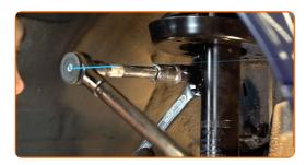
Trate os fixadores do amortecedor. Trate todas as juntas de conexão do estabilizador. Use massa de cobre.
