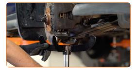
Retire os parafusos de fixação.
