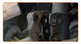
Desaperte a fixação do suporte superior do braço do amortecedor. Use uma chave combinada nº 19. Use uma chave soquete nº 9. Use uma chave de catraca.
