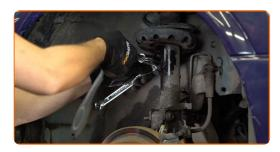
Desaparafuse o elemento de fixação inferior que liga a coluna de suspensão às mangas de eixo. Use uma chave combinada nº 18. Use uma chave soquete nº 18. Use uma chave de tarraxa.
