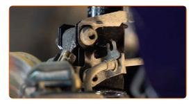
Aperte os fixadores inferiores que conectam a coluna de suspensão à manga de eixo. Use uma chave combinada nº 18. Use uma chave soquete nº 18. Use uma chave de torque. Aperte-o para o torque de 90 Nm.+45°
