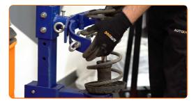
Retire o amortecedor antigo do compressor hidráulico de mola.
