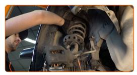
Coloque o suporte do amortecedor sobre a ferramenta de compressão da mola.
