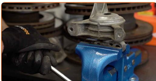
**19** Desaparafuse o apoio do motor do suporte. Use Torx T55. Use uma chave de catraca.
