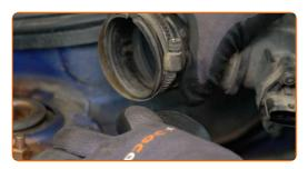
Desaperte as braçadeiras que fixam o sensor de fluxo da massa de ar ao tubo de ar. Use uma chave de fenda plana.
