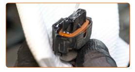
Junte o conector do sensor de fluxo de massa de ar.
