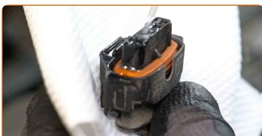
**13** Junte o conector do sensor de fluxo de massa de ar.
