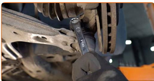
**8** Remova o parafuso de fixação. Use um saca-pino. Use um martelo de borracha.
