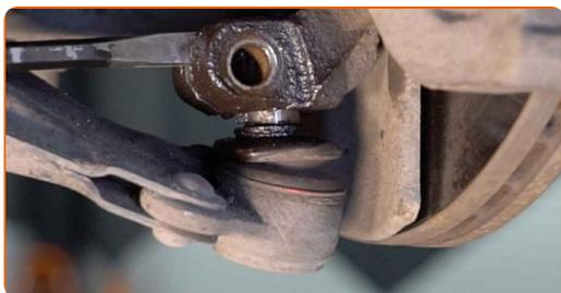
**9** Limpe todas as juntas do braço. Use uma escova metálica. Use spray WD-40.
