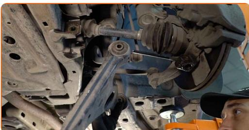
**16** Limpe os locais de montagem e a rosca do braço da suspensão. Use uma escova metálica. Use spray WD-40.
