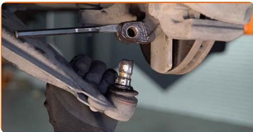
**14** Retire os parafusos de fixação.
