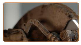
Limpe a sujidade do parafuso da mangueira do travão. Use uma escova metálica. Utilize um produto de limpeza para travões.
