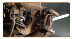
Limpe os elementos de fixação do disco de travão. Use uma escova metálica. Use spray WD-40.
