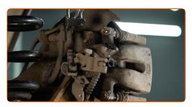
Desaparafuse a fixação de pinça de travão. Use uma chave combinada nº 13.
