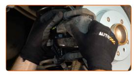
Aperte os fixadores da pinça do travão. Use uma chave combinada nº 17. Use uma chave soquete nº 13. Use uma chave de torque. Aperte-o para o torque de 25 Nm.
