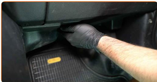
**22** Aparafuse os fixadores do painel de revestimento inferior. Use Torx T20.
