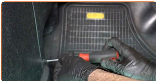
**23** Instale os cliques do painel de revestimento inferior.
