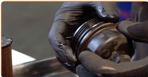
**18** Instale o novo filtro de óleo no assento de montagem na tampa do filtro.
