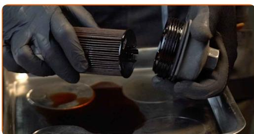
**15** Remova o anel O-ring de vedação da tampa do filtro de óleo. Use uma chave de fenda plana.
