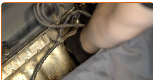
**26** Aparafuse a tampa. Use uma chave soquete nº 24. Use uma chave de torque. Aperte-o para o torque de 25 Nm.
