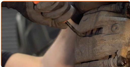
**9** Desaparafuse a fixação de pinça de travão. Use uma chave soquete nº 12. Use uma chave de catraca.
