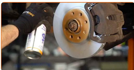
Substituição: discos de travão – OPEL Combo C Tour. Conselho:
