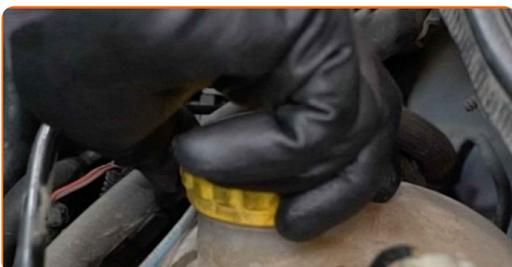
**38** Ligue o motor por alguns minutos. Isto deve ser feito de modo a remover o ar residual do sistema de refrigeração e para verificar se os componentes estão a funcionar corretamente.
