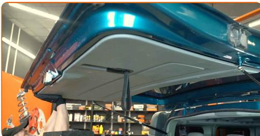
3 Desaparafusar os elementos de fixação da luz de travagem suplementar. Utilizar uma chave de caixa de 8 mm. Utilizar uma chave de roquete.
