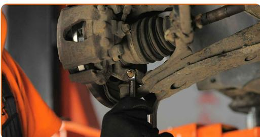
8 Remova o parafuso de fixação. Use um martelo.
