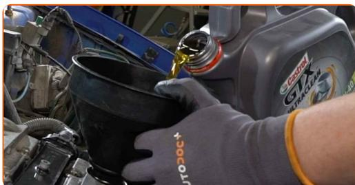
Substituição: óleo do motor e filtro – OPEL Corsa A CC (S83). Os especialistas da AUTODOC recomendam:
