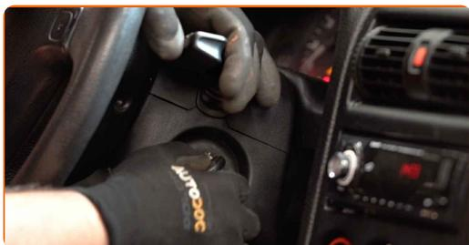
8 Puxe a alavanca do limpa para-brisas para a posição inferior. Ao fazer isso, irá mudar os limpa para-brisas do modo de serviço para o modo de operação.
