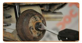
Coloque o contrapino na porca de fixação do rolamento do cubo. Use alicates de ponta arredondada.
