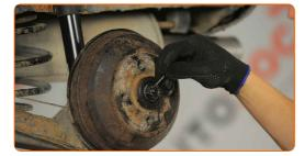
25 Instale a tampa de proteção do rolamento do cubo. Use um martelo de borracha.
