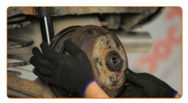
Aparafuse o fixador do cubo da roda. Use uma chave combinada nº 24. Use uma chave de catraca.
