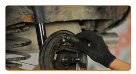
Aperte o fixador do cilindro de roda. Use uma chave soquete nº 10. Use uma chave de torque. Aperte-o para o torque de 10 Nm.
