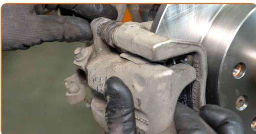
**19** Aperte o fixador da mangueira de travão. Use uma chave soquete nº E11. Use uma chave de torque. Aperte-o para o torque de 15 Nm.
