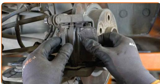
Substituição: pastilhas de travão – OPEL Corsa C Hatchback (X01). Conselho da AUTODOC:
