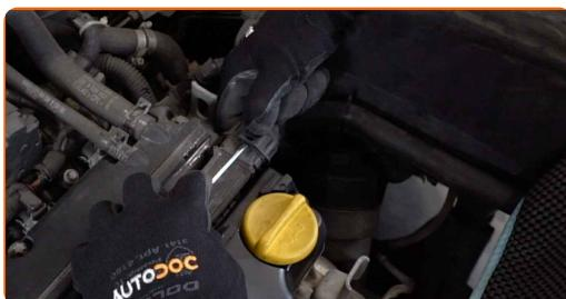
**4** Desaperte o suporte da bobina de ignição. Use Torx T30. Use uma chave de catraca.
