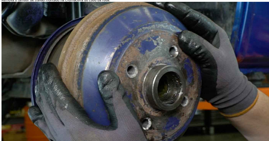
Substituição: maxilas de travão - OPEL Corsa C Van (X01). Conselho de especialistas da AUTODOC:
