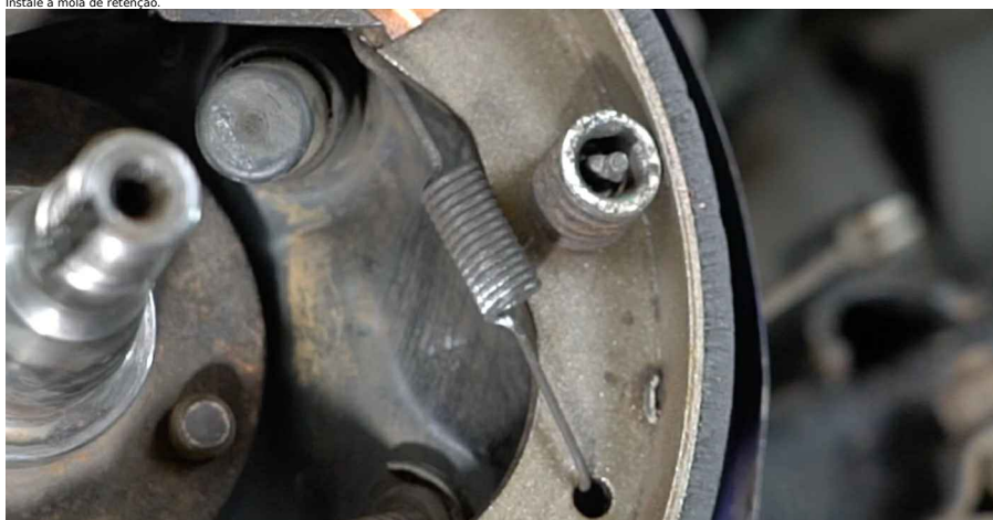
40 Instale a mola de retorno superior. Utilize um alicate de ponta longa.
