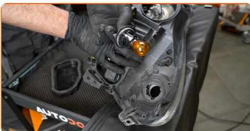
Substituição: farol principal – OPEL Corsa D Van (S07). Conselho da AUTODOC:
