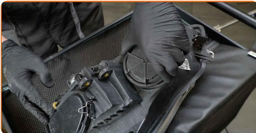
Substituição: farol principal – OPEL Corsa D Van (S07). Conselho:
