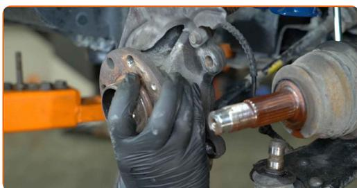
**32** Aperte o cubo de roda juntamente com o rolamento através de um torno.
