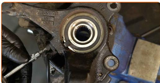
**48** Aperte o fixador que liga o sensor de ABS ao manga de eixo. Use HEX n.º H5. Use uma chave de torque. Aperte-o para o torque de 13 Nm.
