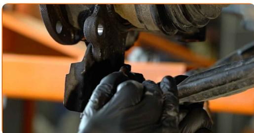
**55** Instale o parafuso de fixação.
