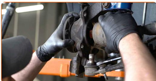
**Substituição: rolamento da roda – OPEL Corsa D Van (S07). Conselho:**
