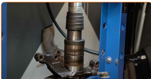
Substituição: rolamento da roda – OPEL Corsa D Van (S07). AUTODOC recomenda:
