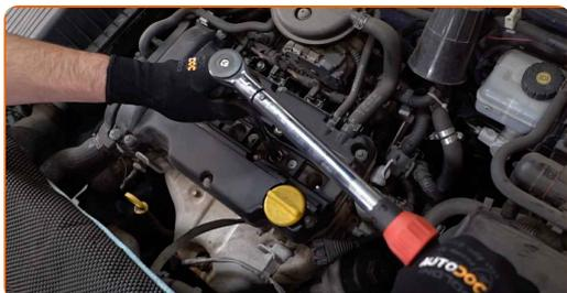
Substituição: vela de ignição – OPEL Corsa E Hatchback (X15). AUTODOC recomenda:
