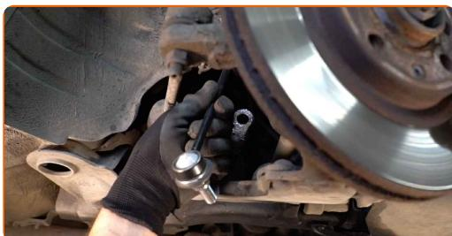
**12** Aperte o fixador que conecta a bieleta da barra estabilizadora à barra estabilizadora. Use uma chave combinada nº 17. Use uma chave soquete nº 19. Use uma chave de torque. Aperte-o para o torque de 60 Nm.
