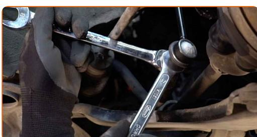
**13** Desaparafuse o fixador que conecta bieleta da barra estabilizadora à barra estabilizadora. Use uma chave soquete nº 19. Use uma chave de torque. Aperte-o para o torque de 60 Nm.
