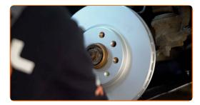
Aperte a fixação do disco de travão. Use Torx T30. Use uma chave de torque. Aperte-o para o torque de 7 Nm.
