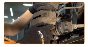
Aperte os fixadores da pinça do travão. Use uma chave soquete nº 12. Use uma chave de torque. Aperte-o para o torque de 27 Nm.
