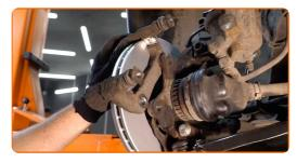
Aperte a braçadeira da pinça do travão. Use uma chave soquete nº E18. Use uma chave de torque. Aperte-o para o torque de 100 Nm.
