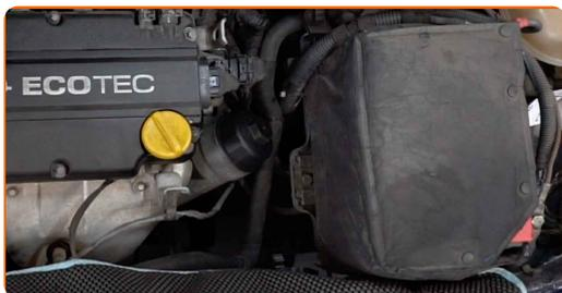
6 Desaperte a tampa da caixa do filtro em conjunto com o antigo elemento do filtro. Use uma chave soquete nº 32. Use uma chave de catraca.
