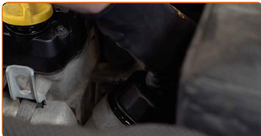
28 Aparafuse a tampa. Use uma chave soquete nº 32. Use uma chave de torque. Aperte-o para o torque de 15 Nm.
