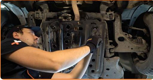
11 Remova a tampa do cárter de óleo. Use uma chave soquete nº 12. Use uma chave de catraca.
