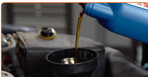
Substituição: óleo do motor e filtro – OPEL Corsa C Van (X01). Conselho de especialistas da AUTODOC:
