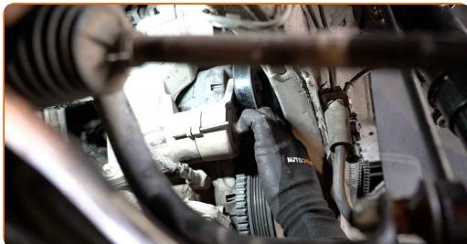
Substituição: correia trapezoidal estriada – OPEL Corsa Utility Pick-up.
