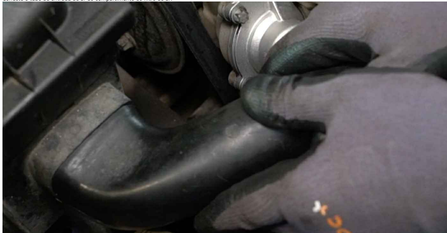
32 Coloque a clipe no tubo de entrada do filtro de ar.
