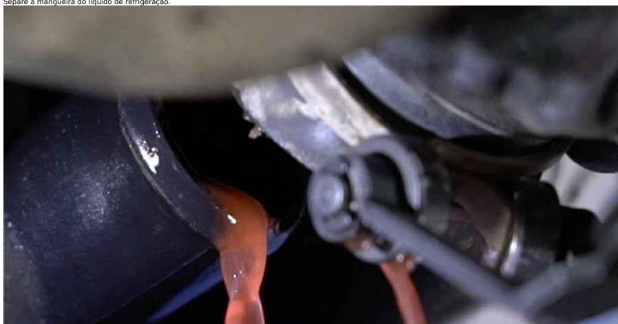
8 Separe a mangueira do líquido de refrigeração.
