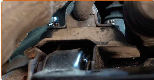
8 Retire os parafusos de fixação (2 peças).
