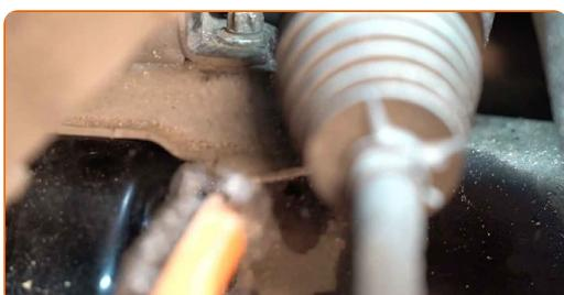
7 Desaperte os fixadores dos suportes da bucha da barra estabilizadora. Use uma chave combinada nº 13.
