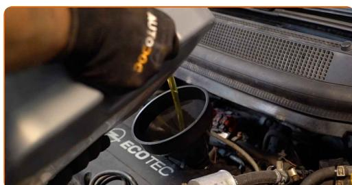
Substituição: óleo do motor e filtro – OPEL Meriva B (S10). AUTODOC recomenda:
