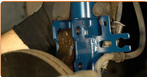
**43** Instale os parafusos de fixação.
