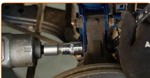
**49** Instale o terminal do estabilizador transversal.
