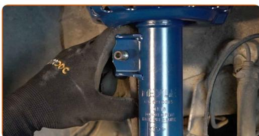
**50** Desaparafuse o fixador que conecta bieleta da barra estabilizadora à barra estabilizadora. Use uma chave soquete nº 19. Use uma chave combinada nº 19. Use uma chave de torque. Aperte-o para o torque de 55 Nm.
