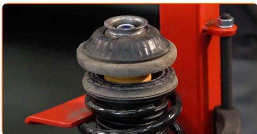
**36** Aperte a porca do suporte do amortecedor da haste do pistão. Use HEX n.º H6. Use uma chave soquete n.º 22. Use uma chave de torque. Aperte-o para o torque de 65 Nm.
