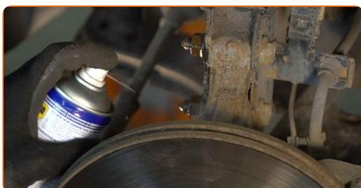
**17** Desaparafuse o elemento de fixação inferior que liga a coluna de suspensão às mangas de eixo. Use uma chave combinada nº 18. Use uma chave soquete nº 18. Use uma chave de tarraxa.
