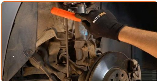
**14** Desaperte a porca e remova a barra estabilizadora do amortecedor. Use uma chave combinada nº 19. Use uma chave soquete nº 19. Use uma chave de catraca.
