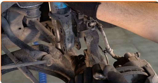
**24** Remova o retentor do suporte superior do amortecedor.
