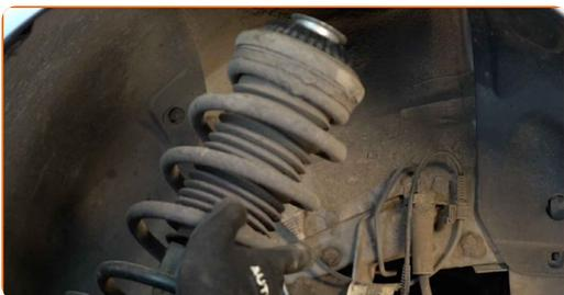
**26** Coloque o suporte do amortecedor sobre a ferramenta de compressão da mola.
