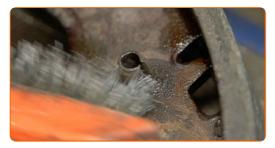
Desmonte o perno. Use alicates de bomba de água.
