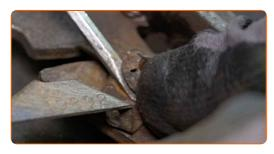
Remova a alavanca de ajuste da sapata de travão.
