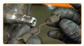
Desligue o cabo do travão de estacionamento.
