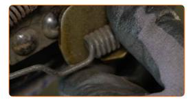
Instale os retentores das sapatas do travão de tambor. Utilize um compressor de molas de retenção das maxilas do travão.
