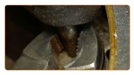
Instale a alavanca de ajuste da sapata de travão.
