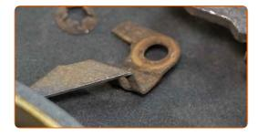
Limpe o local de montagem do perno. Use uma escova metálica. Use spray WD-40.
