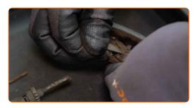
Remova o anel elástico. Use uma chave de fenda plana.
