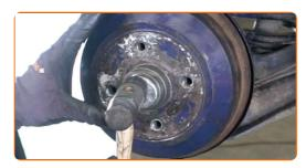
Trate da superfície onde a jante da roda entra em contacto com o tambor de travão. Utilize massa lubrificante de cerâmica.
