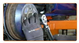
Aperte os parafusos da roda. Use o soquete de impacto para roda #17.
