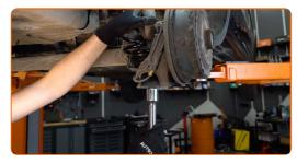
Limpe os locais de montagem do amortecedor. Use uma escova metálica. Use spray WD-40.
