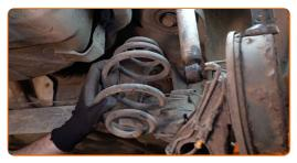
Limpe os locais de montagem da mola espiral. Use uma escova metálica. Use spray WD-40.
