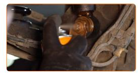
Limpe o local de montagem do aro do pneu. Use uma escova metálica. Trate a superfície de contacto. Use massa de cobre.
