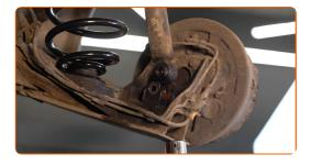
Remova o apoio sob a viga do eixo traseiro.
