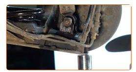
Aperte a fixação inferior do amortecedor. Use uma chave soquete nº E14. Use uma chave de torque. Aperte-o para o torque de 110 Nm.
