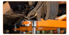
Conecte a parte inferior do amortecedor.
