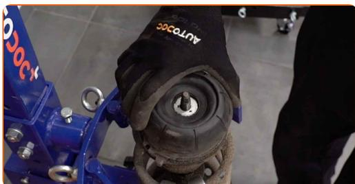
24 Instale o novo suporte do amortecedor, o fole e o batente no amortecedor.
