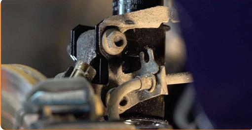
**37** Fixe o tirante da barra estabilizadora do suporte de suspensão. Use uma chave combinada nº 19. Use uma chave soquete nº 18. Use uma chave de torque. Aperte-o para o torque de 65 Nm.
