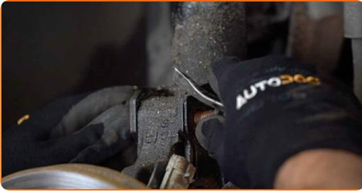
**16** Desligar a mangueira do travão do suporte do amortecedor. Use uma chave de fenda plana.
