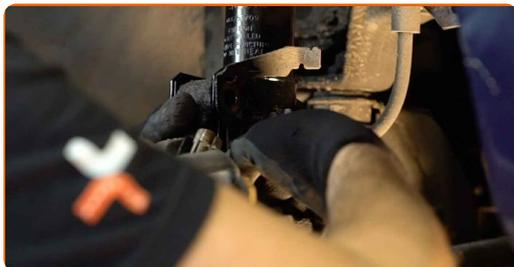
**33** Aperte os fixadores inferiores que conectam a coluna de suspensão à manga de eixo. Use uma chave combinada nº 18. Use uma chave soquete nº 18. Use uma chave de torque. Aperte-o para o torque de 90 Nm.+45°
