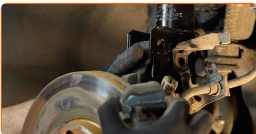
**32** Instale os novos parafusos das mangas de eixo.
