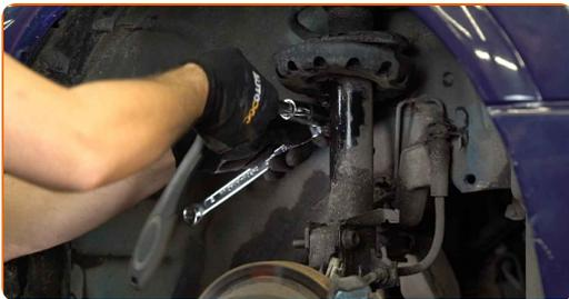
13 Desaparafuse o elemento de fixação inferior que liga a coluna de suspensão às mangas de eixo. Use uma chave combinada nº 18. Use uma chave soquete nº 18. Use uma chave de tarraxa.
