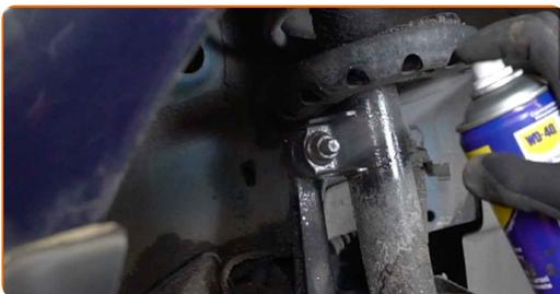
12 Desaperte a porca e remova a barra estabilizadora do amortecedor. Use uma chave combinada nº 19. Use uma chave soquete nº 18. Use uma chave de catraca.
