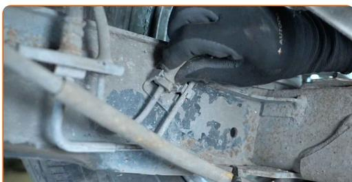
**6.2** Desligar o conector do veículo do conector do sensor do ABS.
