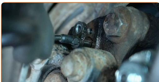
**6.1** Desmontar a cablagem do sensor do ABS.
