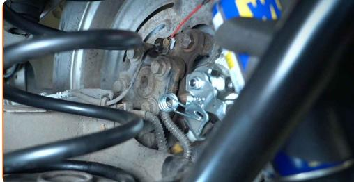
**3** Desenroscar o elemento de fixação do sensor do ABS. Utilizar um bit Torx T30. Utilizar uma chave de roquete.
