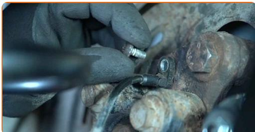
**5** Desmontar o sensor do ABS. Utilizar uma alavanca de montagem.
