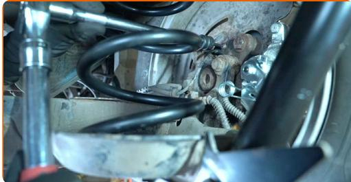
**4** Desmontar o parafuso de fixação.
