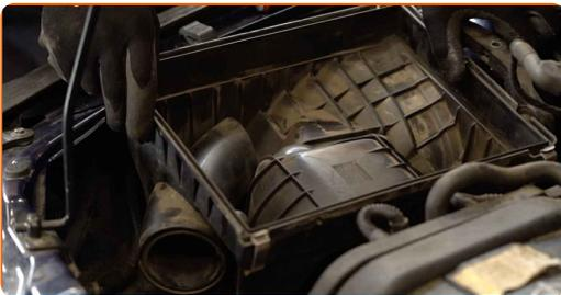
33 Apertar os parafusos de fixação da caixa do filtro. Use Torx T30. Use uma chave de catraca.
