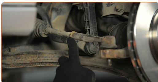
**11** Solte a porca de bloqueio que prende o terminal de direção à barra de direção. Use uma chave combinada nº 22.
