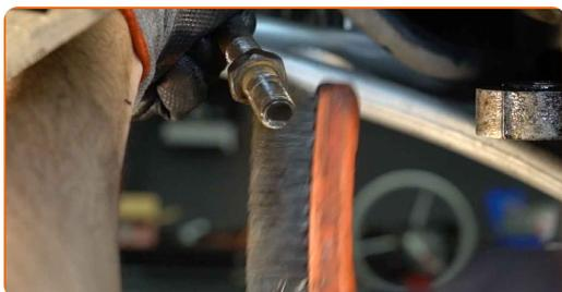
**14** Trate dos assentos de montagem do terminal da direção. Use massa de cobre.
