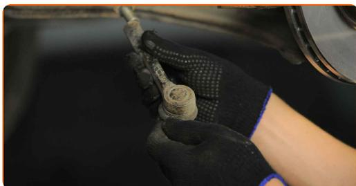
**13** Limpe os assentos de montagem do terminal da direção. Use uma escova metálica. Use spray WD-40.
