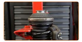
Retire a coluna de suspensão montada.
