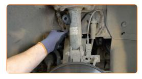
Limpe os fixadores que ligam a mangueira do travão ao amortecedor. Use uma escova metálica. Use spray WD-40.
