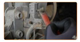
Remova o elemento de fixação que prende a mangueira de travão ao amortecedor. Use alicates.
