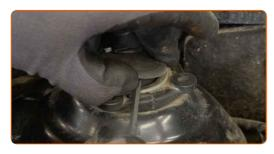
Remova o retentor do suporte superior do amortecedor. Use uma chave de fenda plana.
