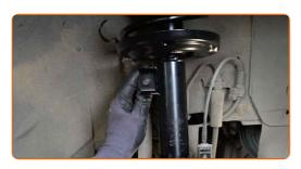
Desaparafuse o fixador que conecta bieleta da barra estabilizadora à barra estabilizadora. Use uma chave combinada nº 17. Use uma chave soquete nº 18. Use uma chave de torque. Aperte-o para o torque de 55 Nm.
