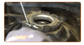
Retire os parafusos de fixação.
