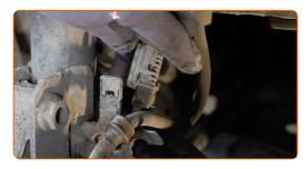
Limpe os fixadores que conectam as colunas de suspensão às mangas de eixo. Use uma escova metálica. Use spray WD-40.
