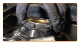
Instale a tampa do apoio da coluna de suspensão.
