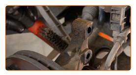
Instale o amortecedor no arco da roda.
