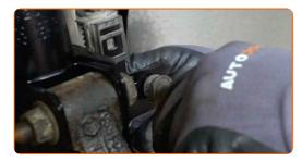
Instale o clipe de retenção da mangueira de travão. Use um martelo.
