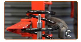
Instale o suporte, a coifa e o batente de encosto do amortecedor no novo amortecedor.
