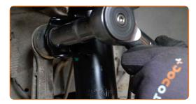
Trate os fixadores do apoio da coluna de suspensão. Trate os fixadores da manga de eixo. Use massa de cobre.
