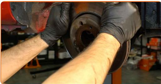
**18** Limpe o cubo. Use uma escova metálica. Trate a superfície de contacto. Use massa de cobre.
