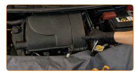
Instale os grampos de fixação do tubo de respiro do filtro de ar e do tubo de entrada do filtro de ar. Utilize alicates de anel clic-R.
