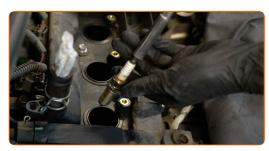
Aplique uma camada fina de um lubrificante antigripante de alta temperatura específico às roscas das novas velas de ignição. Use uma chave de fenda plana.
