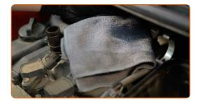
7 Limpe as bobinas de ignição.
