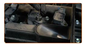
Trate o conector da bobina de ignição com spray eletrónico. O spray protegerá os contactos elétricos contra a corrosão, oxidação e reduzirá a resistência do contacto.
