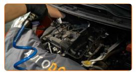
B Desconecte os conectores das bobinas de ignição.
