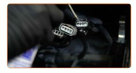
Ligue os conectores das bobinas de ignição.
