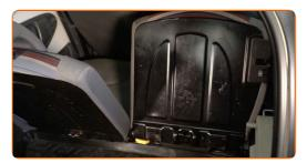
Remova os grampos do forro lateral do porta-malas. Use uma ferramenta de remoção de clipe.
