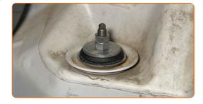
Desaperte a fixação superior do amortecedor. Use uma chave combinada nº 14 (2 peças). Utilize a chave para amortecedor DD nº 6.
