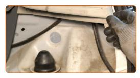
Retire a cobertura de suporte do elemento fixador do amortecedor.
