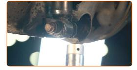
Aperte a fixação inferior do amortecedor. Use uma chave soquete nº 14. Use uma chave de torque. Aperte-o para o torque de 48 Nm.
