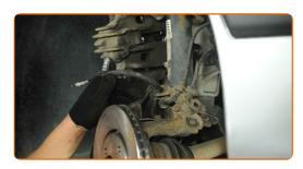
Desconecte a cablagem do sensor ABS. Utilize um pé-de-cabra.
