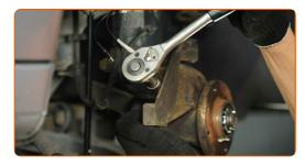
62 Conecte a extremidade do terminal de direção à manga de eixo.
