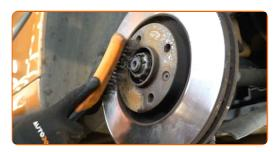
Desenrosque os parafusos do disco de travão. Use a chave Phillips.
