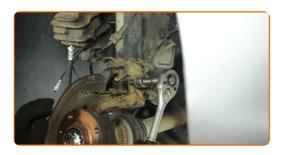
66 Conecte a cablagem do sensor ABS.
