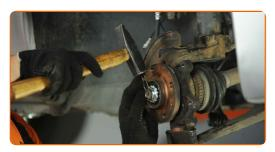
Instale o sensor de ABS na manga de eixo e fixe-o. Use uma chave soquete nº 10. Use uma chave de catraca.
