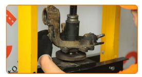
Trate o assento de montagem da coluna de suspensão na manga de eixo. Use uma escova metálica. Use spray WD-40.
