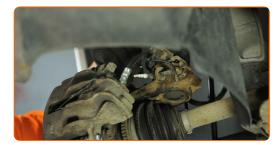
Trate a porca de fixação conectada ao terminal de direção à manga de eixo. Trate os fixadores da manga de eixo. Trate os fixadores do suporte da pinça de travão. Trate os fixadores que ligam o braço da suspensão à manga do eixo. Use massa de cobre.
