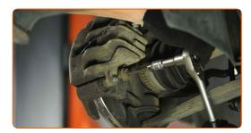
Retire os parafusos de fixação (2 peças).
