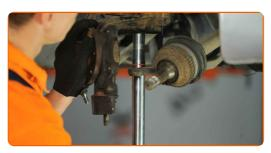
Fixe o suporte do amortecedor na manga de eixo. Use um martelo.
