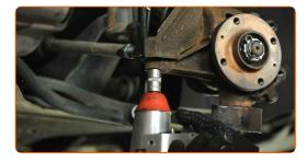
Instale o apoio no suporte do amortecedor.
