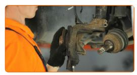
Desaparafuse o fixador que liga o sensor de ABS à manga do eixo. Use uma chave soquete nº 10. Use uma chave de catraca.
