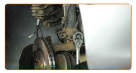
Remova o apoio do suporte do amortecedor.
